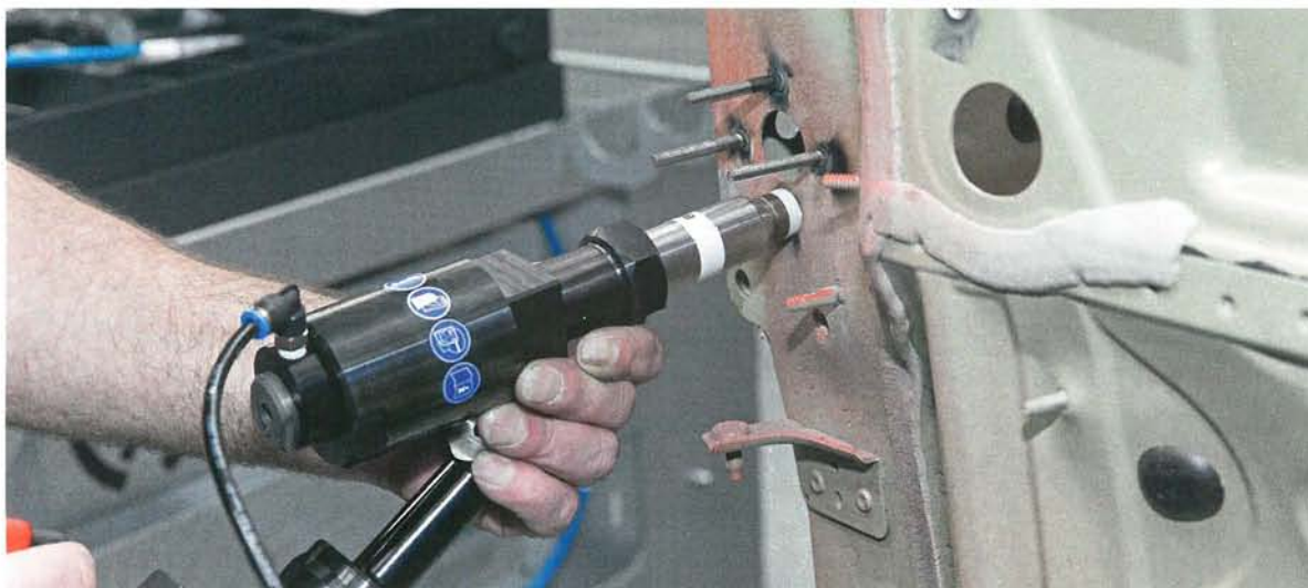
Miracle AluRepair und das XPress 800 Nietsystem arbeiten beim Ausziehen von Stanznieten Hand in Hand.
