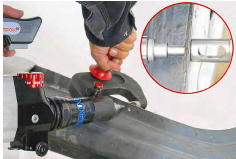
Zu sehen ist hier die Verarbeitung eines hochfesten Blindnietes an einem Testa-Schweller.
