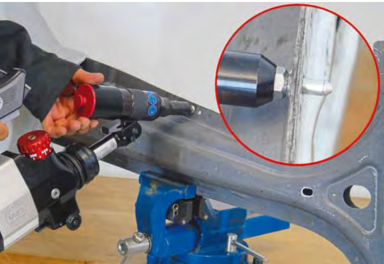
Die neue XPress SC im Einsatz beim Lochstanzen als Vorbereitung zum Setzen eines Blindnietes in ultrahochfestem Stahl. (Fotos: Wieländer+Schill)
